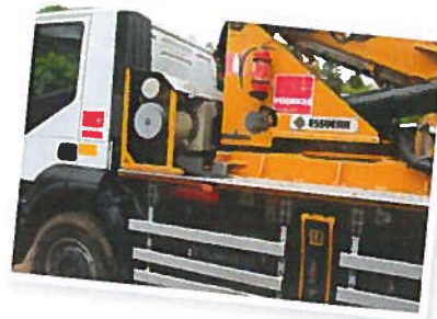
Alle Veidekkes maskiner som brukes i tunnel er utstyrt med brannslukningsutstyr.
